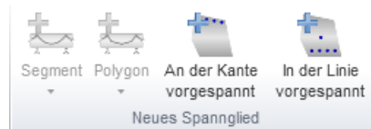
Abbildung 3.26: Schaltflächengruppe Neues Spannglied für sofortigen Verbund
