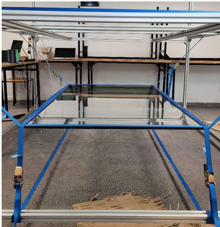
Rysunek 5.1 Sposób podparcia badanych elementów za pomocą elastycznych taśm
